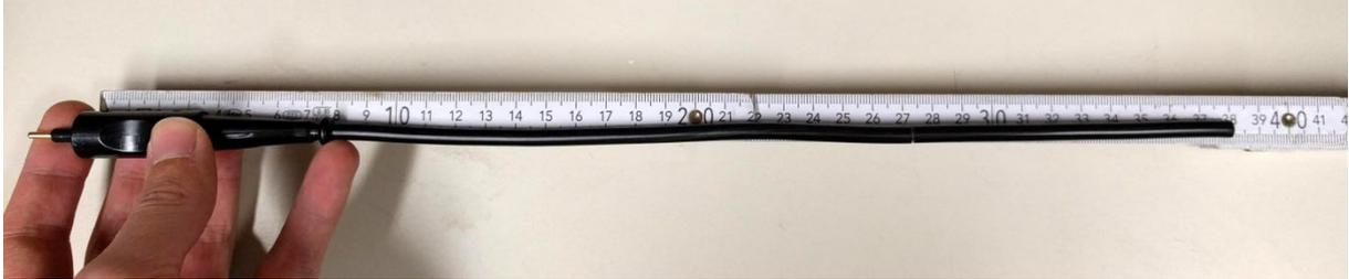
2. Anschließend müsst ihr den Kabelmantel auf einer Länge von 11cm entfernen. Dazu schneidet ihr ihn mit einem scharfen Cutter ein und zieht ihn ab. **TIPP:** Sollte es zu schwer gehen, dann macht noch einen Zwischenschnitt und entfernt den Mantel auf zwei Mal.
