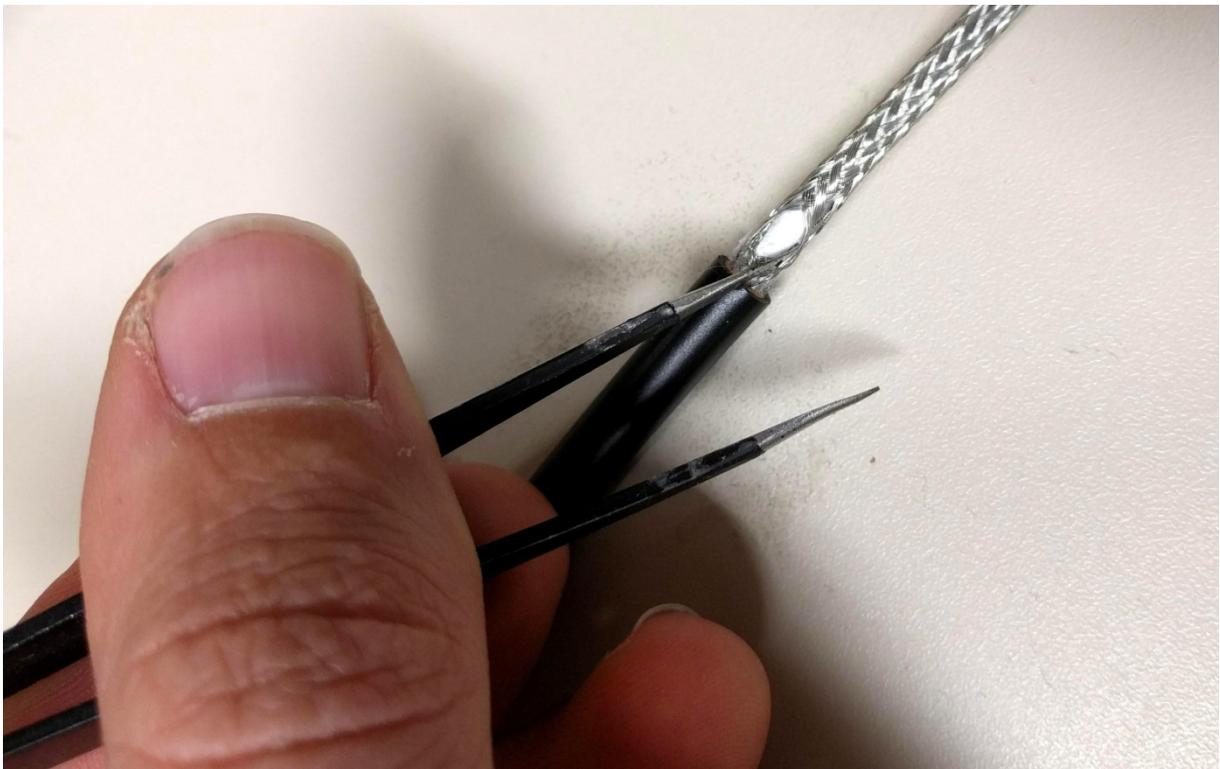
4. Anschließend biegt ihr das Kabel an genau dieser Stelle um und schiebt die Litzen weiter auseinander
