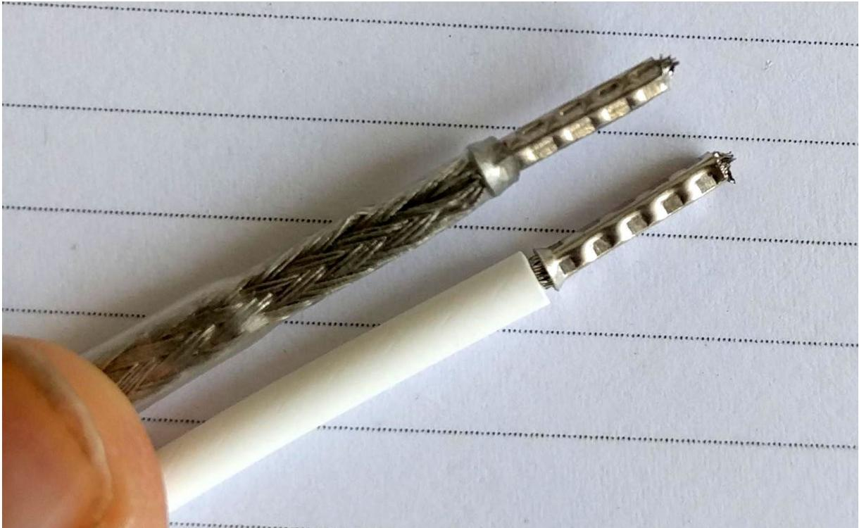
10. Mit einem Schrumpfschlauch isoliert ihr das Schirmgeflecht anschließend noch. **TIPP:** ein zweiter, kurzer Schrumpfschlauch schützt auch die noch heraushauenden Litzen an der Übergangsstelle.
